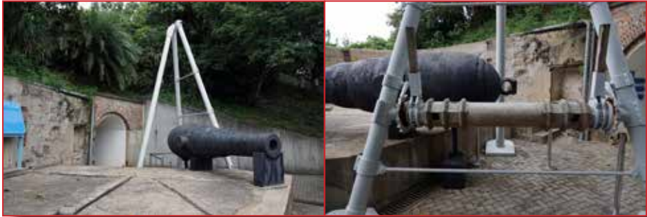
Fort Lei Yue Mun – Pièce 9-Inch RML (12 tonnes) et sa chèvre de levage (2016)
